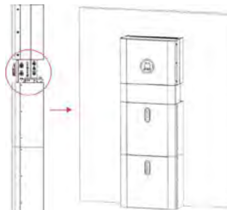
Figura 31 Chiusura del quadro elettrico
