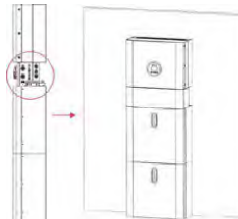
Figura 31 Chiusura del quadro elettrico
